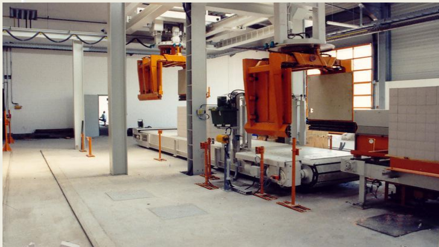
Speicherplattenband mit Manipulatoren Storing Board Belt with Manipulators
