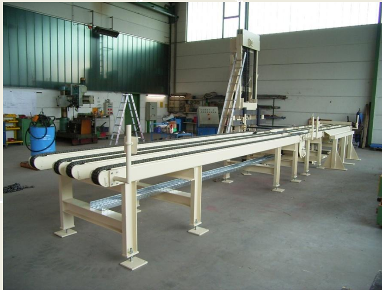
Förderlinie mit Doppler Conveying Line with Doppler
