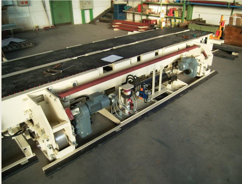
Querverfahrwagen mit Notaushub Cross Sliding Platform with Emergency Excavation
