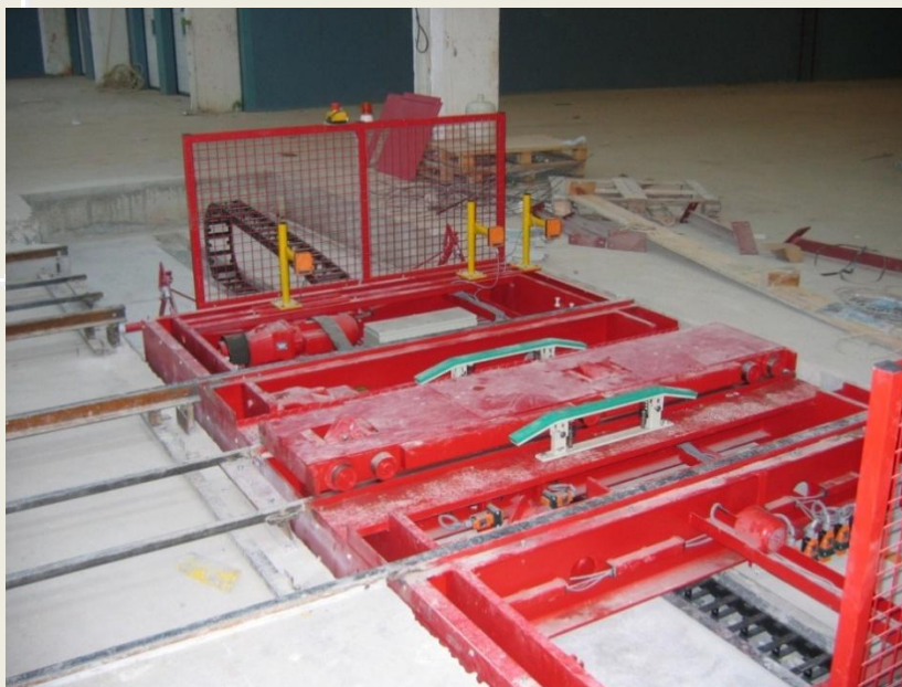
Schiebebühne für Tunnelofenwagen Transfer Car for Kiln Car
