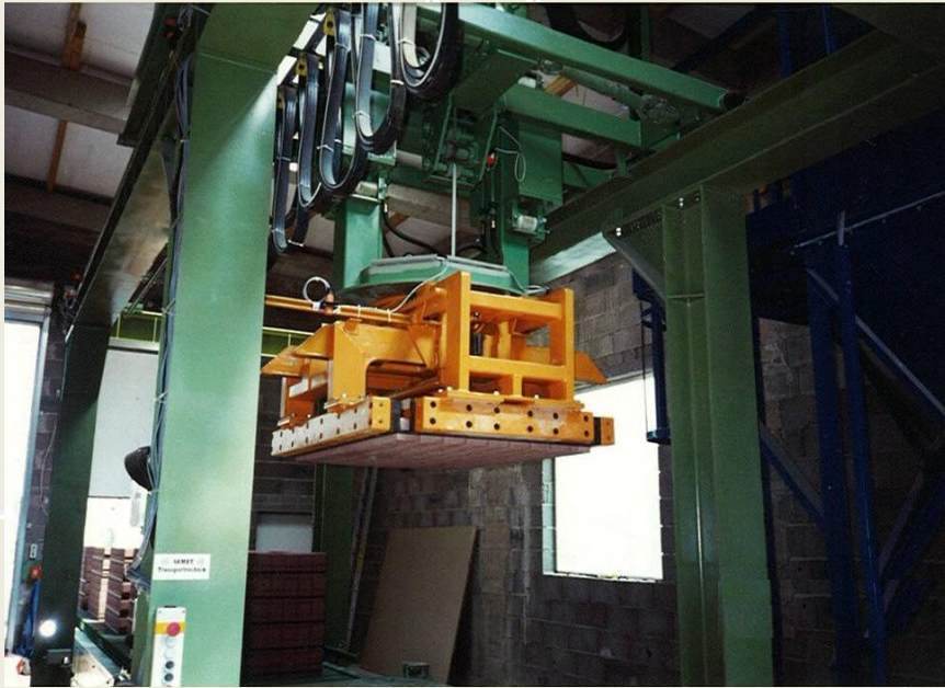
Stapelkran Piling Crane
