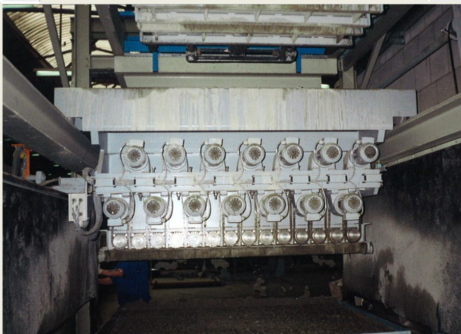
Betonverteiler Concrete Distributor
